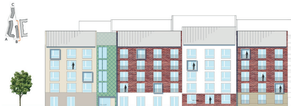
Illustration av det södra bostadskvarteret (hus B) mot Lergropsvägen visar fasad med mer än 30 % genomskiktighet i bottenvåning (första våning). Illustration från MAF Arkitekter.
