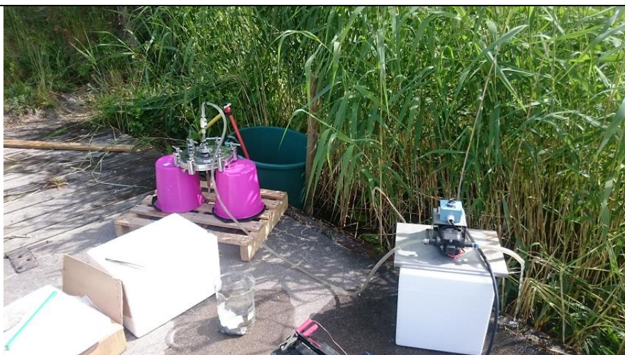
Figur 1 Partikelfilter (i hållare) och polyuretanfilter (PUF, i glasampull) samlar upp substanser som pumpas via slangar från behållaren i fält. Vattnet flödar uppåt/åt höger i bilden.
