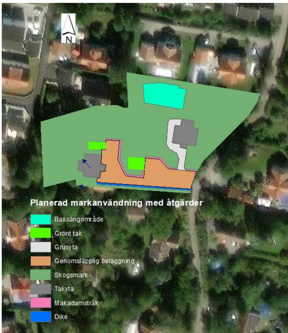
Figur 11. Schematisk placering av föreslagna åtgärder inom planområdet. Takvatten från det planerade bostadshuset föreslås ledas yttligt till omgivande mark och redovisas schematiskt med blåa pilar men kan behöva justeras utefter höjdsättning.
