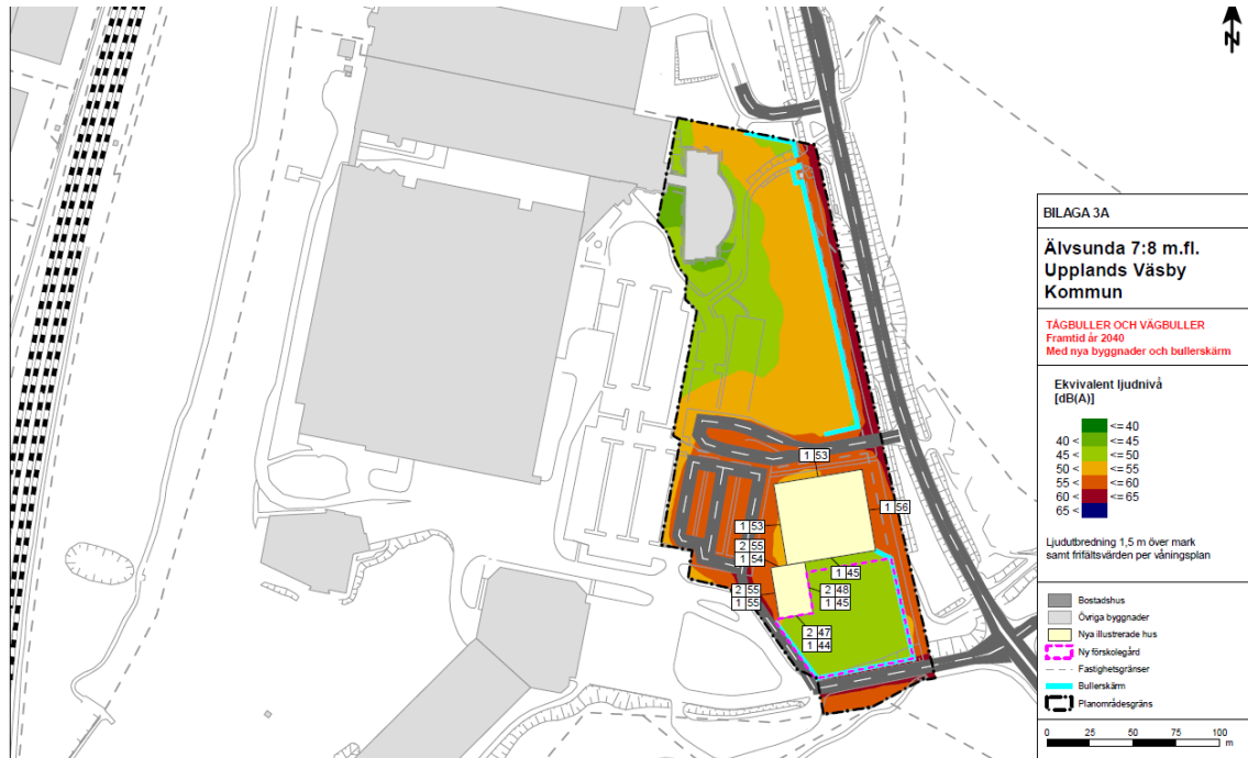
Figur 11. Bullersituationen 2040 med bullerskärm för trafikbuller. Riktvärdet för trafikbuller klaras för mer än 50 % av skolgården på Älvsunda 7:9 och för hela förskolegården på Älvsunda 7:11.
