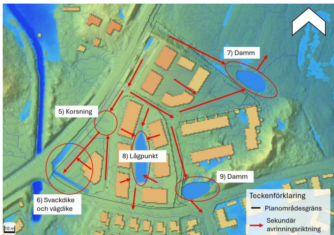
Figur 37. Sekundära avrinningsvägar vid skyfall samt föreslagna lågpunkter för avrinnande skyfallsvatten (Afry 2025).
