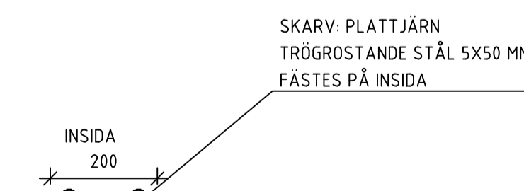
SKARV KANTSTÖD METALL, PLAN SKALA 1:10
