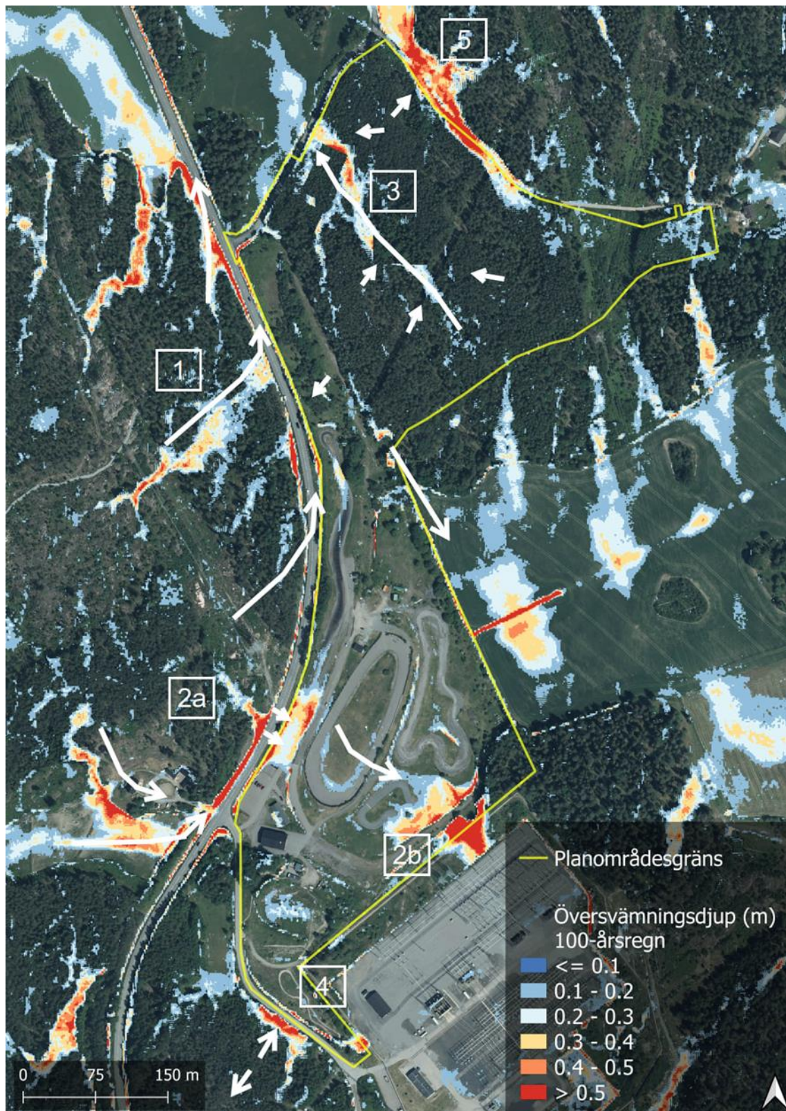
Figur 4. Maximalt översvämningsdjup vid 100-årsregn på befintliga marknivåer före exploatering. Flödesriktningar illustreras av vita pilar och siffrorna 1-5 indikerar resultat som beskrivs i text ovan.
