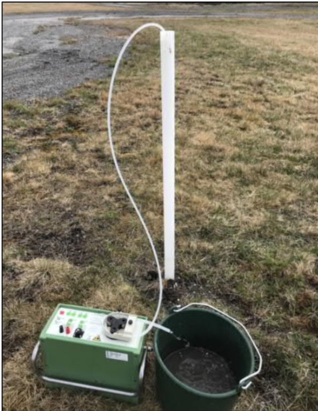
Figur 3: Grundvattenprovtagning med peristaltisk pump.
